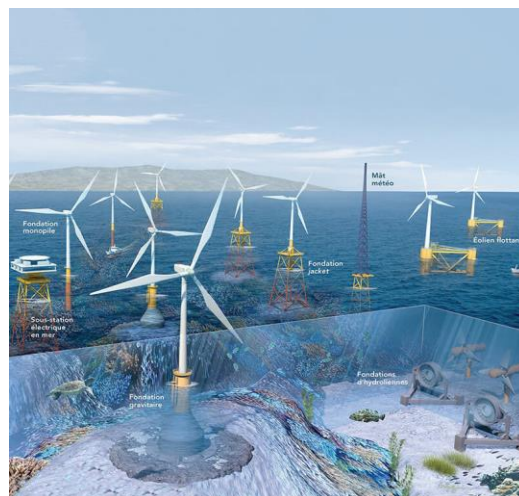
Figure 6 vue d'artiste d'éoliennes avec différents types d'arrimage au sol marin.
